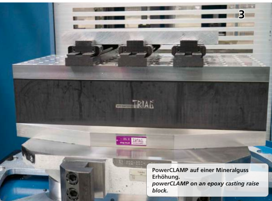
Stahlmineralguss-Säulen mit Power Clamp für die Fertigung von Flügelteilen. Steel epoxy frames machining wing parts on a Makino machine
