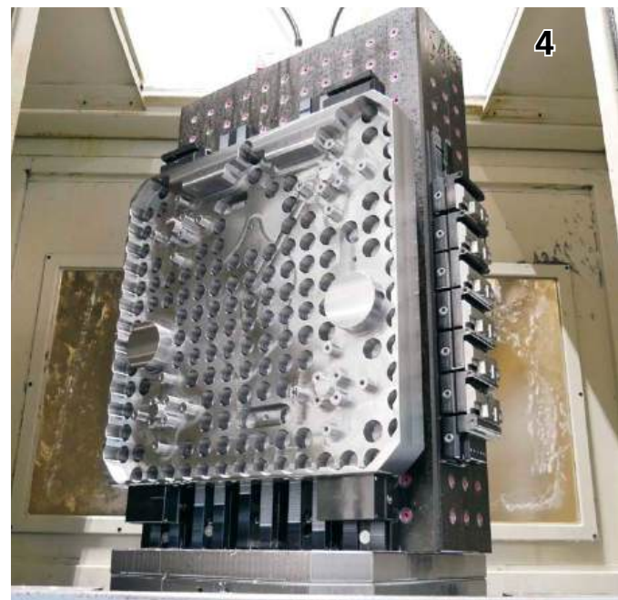
Chaotische Spannung (Tripoxy Mineral) mit unterschiedlichen Werkstücken bestückt. Optimale Nutzung eines Horizontal-Bearbeitungszentrums. Mixed set up on a Mazak horizontal machine with 18 pallets. This is used for unmanned production of small quantities of different materials.
